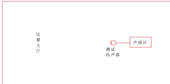
图 5.4.5 背景噪声测量方框图
